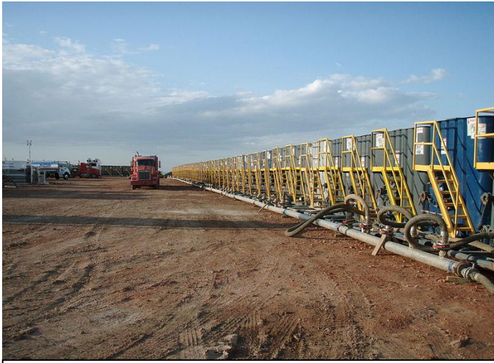
Tanques de agua preparados para el proceso de fractura hidráulica en un pozo. Imagen de Wikipedia
